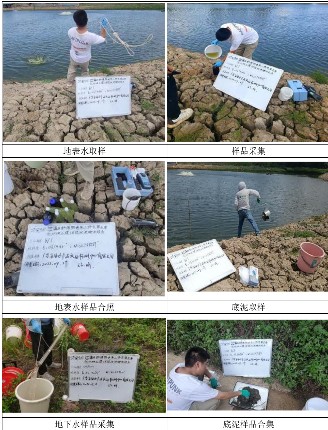
图 3.5-3 地表水和底泥现场采样照片
