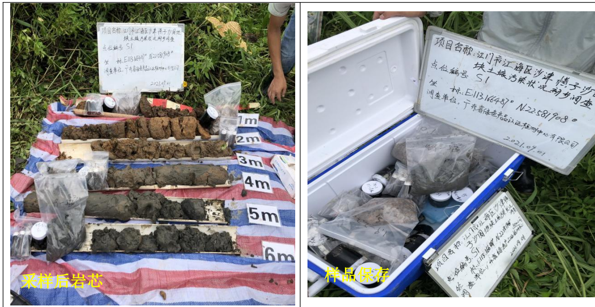
图 4.2-2 土壤样品采集现场照片
